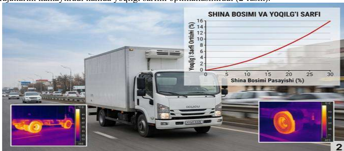
2-rasm. Shina ichki bosimining kamayishi, shina qizishiga va yoqilg'i sarfining oshishiga olib keladi.
