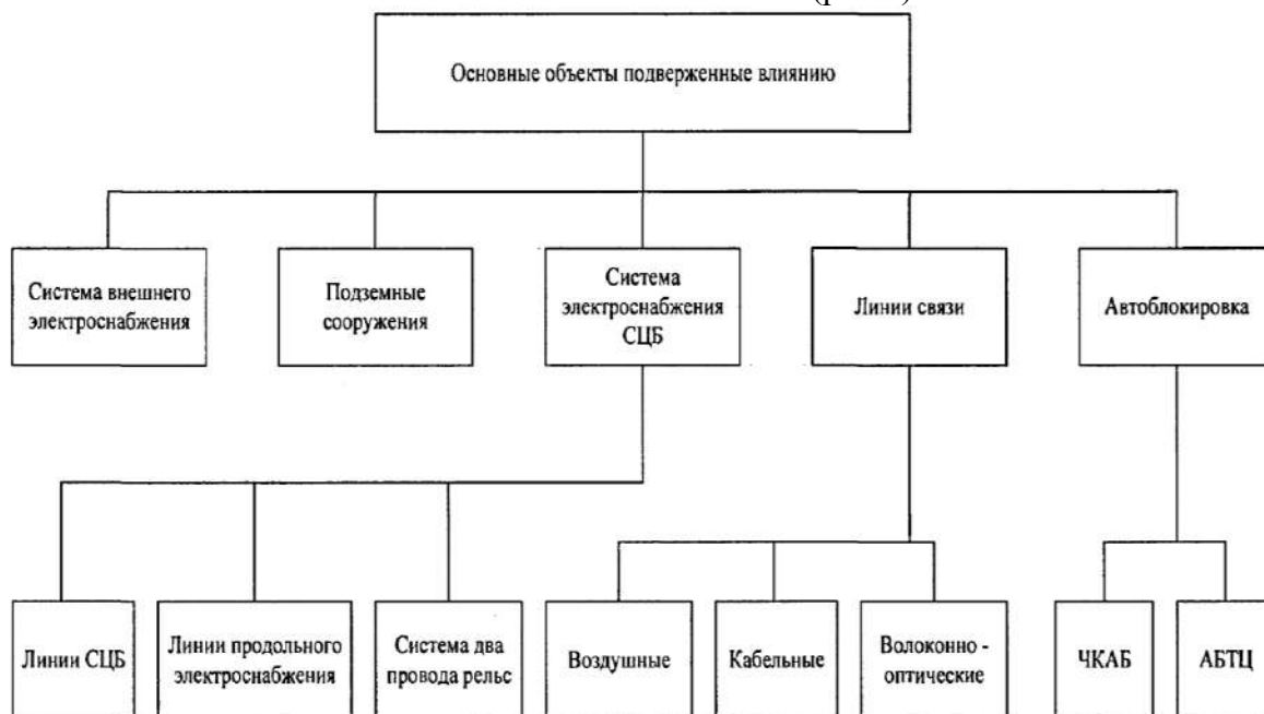
Рис.1. Характеристика влияния тяговой сети на смежные электротехнические коммуникации железнодорожной автоматики и телемеханики
