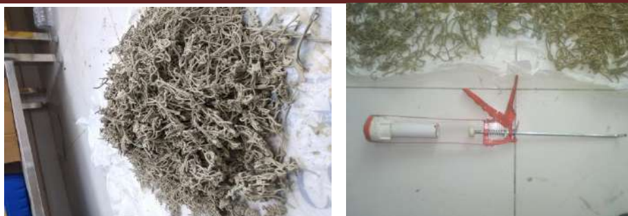
1-rasm. Nam holatdagi modifikatsiyalangan bentonitning maxsus uskuna bilan shakl berish
